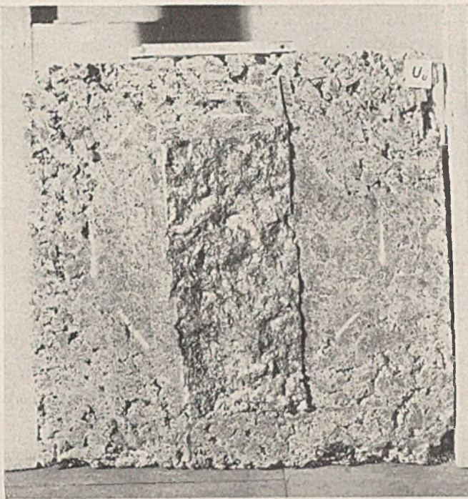
Abb. 21 u. 22. Wirkungsweise von Innenrüttlern in Säulen von 60 cm \times 60 cm Querschnitt.
