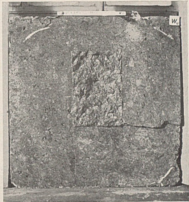
Abb. 21 u. 22. Wirkungsweise von Innenrüttlern in Säulen von 60 cm \times 60 cm Querschnitt.
