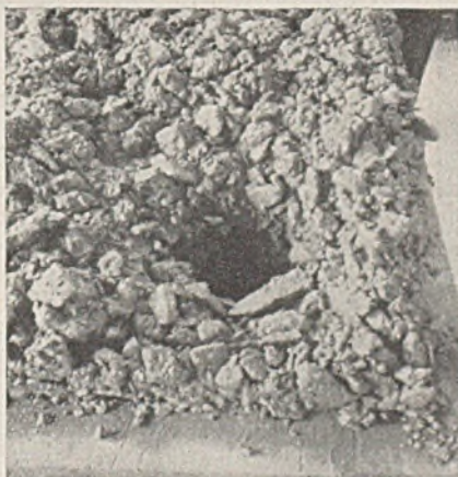
Abb. 16. Rüttelbeton falscher Zusammensetzung (zu wenig feine Teile).
