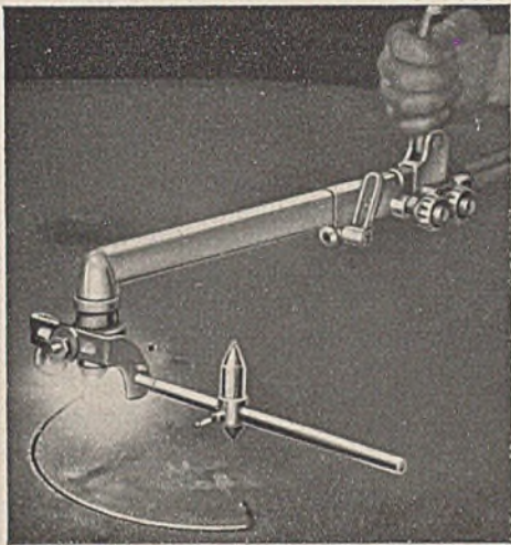
Abb. 20. Gasschneidbrenner („Fortschritt“) von Griesogen mit Zirkelstange zum Schneiden von Löchern.
