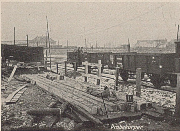
Abb. 39. Thermometeranordnung zur Messung der Abbinde- wärme eines Eisenbetonpfahles. Im Vordergrund die Probekörper 20 · 20 · 20 und 20 · 20 · 10 cm in Säcke gehüllt.
