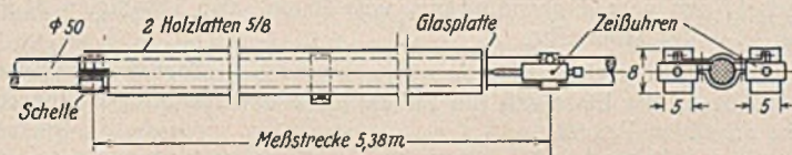
Abb. 11a. Meßanordnung an den Zugseisen.
