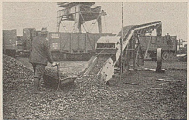
Abb. 2. Handschraper mit Förderband beim Beladen von Eisenbahnwagen.
