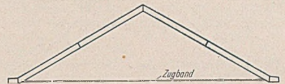
Abb. 23. Falzwerk als Giebeldach.
