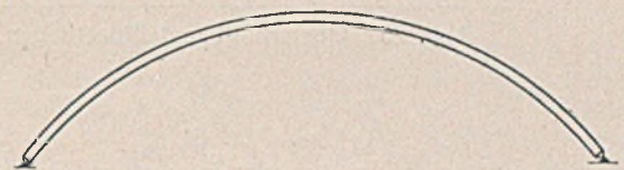
Abb. 24. Gewölbte Schale aus Blechhohlplatten.
