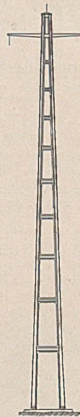
Abb. 53. Rahmenartig verstreber Freileitungsmast.
