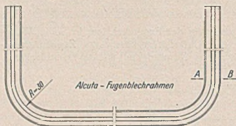
Abb. 13. Fugenblechausbildung mit Schalungskasten für die Abdichtung von Bewegungsfugen in Betonbauwerken.
