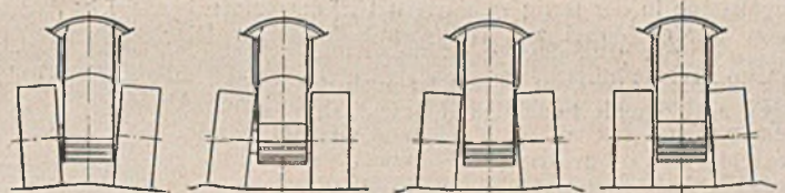
Abb. 3. Verschiedene Einstellungen der Hinterräder mit Kippachsen entsprechend einem Walzquerschnitt.
