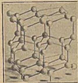
Ryc. 6. Model (blisko miliard razy powiększony) kryształu siarczku cynku (wureytu). Białe kulki przedstawiają atomy siarki, szare kulki — atomy cynku.
