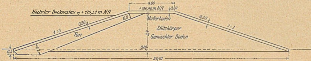
Abb. 5. Querschnitt des Sperrdammes.
