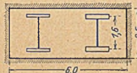
Abb. 7. Verkehrslasten (Fahrzeuge) der Österreichischen Belastungsannahmen für Straßenbrücken Norm I. (Onorm B 6201 Entwurf 2.)
