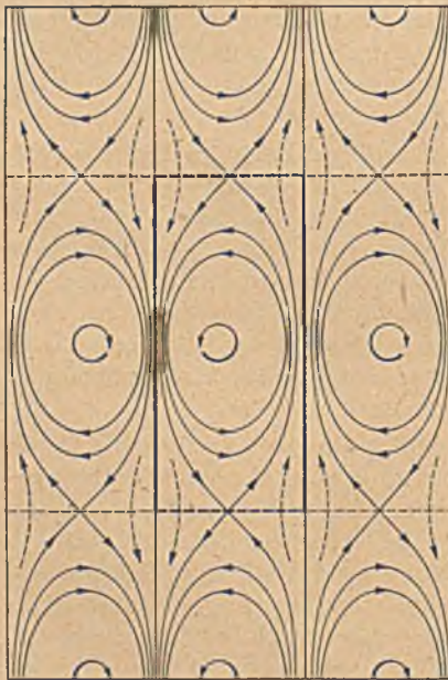
Bild 235. Zwei Kreise mit gleicher und gleichsinniger Zirkulation und die Abbildung ihres Außengebietes auf ein doppelperiodisches System von Wirbeln.
