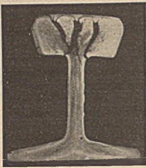
Abb. 6. Schiene mit nicht geschlossenen und im Betriebe aufgerissenen Lunkern. ( 1/3 nat. Größe.)
