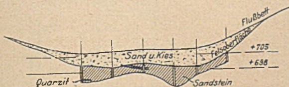
Abb. 5. Geologisches Profil (Schnitt A—A der Abb. 4).
