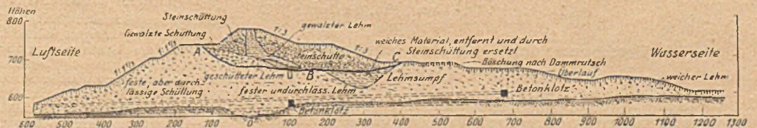
Querschnitt durch den Calaveras-Damm.
