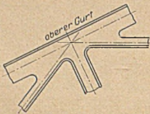
Abb. 1. Geschweißte Verbindungen von T-Trägern.
