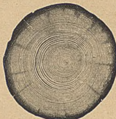
Abb. 2. Querschnitt durch kyanisierte Kiefer.
