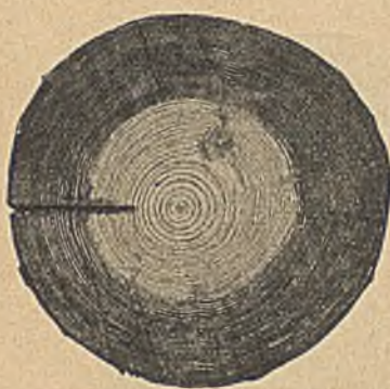
Abb. 1. Kiefer mit Teeröl imprägniert nach dem Rüping-Verfahren.
