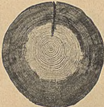
Abb. 1. Kiefer mit Teeröl imprägniert nach dem Rüping-Verfahren.
