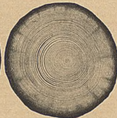
Abb. 2. Querschnitt durch kyanisierte Kiefer.
