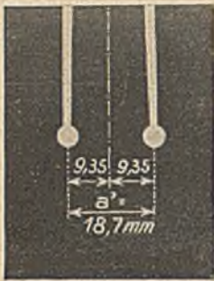
Abb. 11. Schattenbild des schwingenden Massenmittelpunktes bei horizontaler Resonanz n_r = 2250 Schwingungen/Minute.
