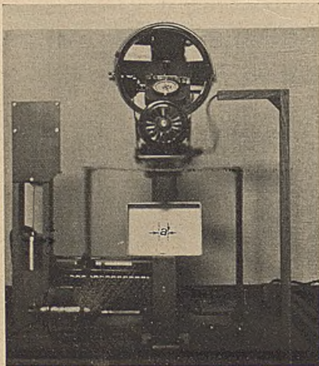
Abb. 12. Lichtbild des schwingenden Rahmens bei horizontaler Resonanz n_r = 2250 Schwingungen/Minute. Die Drehzahl ist hierbei im mitphotographierten Spiegelbild des Drehzählers festgehalten.
