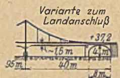
Abb. 5. Vorschlag des Verfassers für eine neue Straßen-Überführung (1924).
