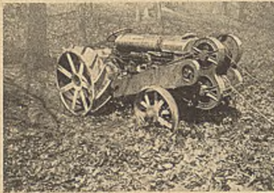
Abb. 8. Winde für Kabelbagger an Fordson.
