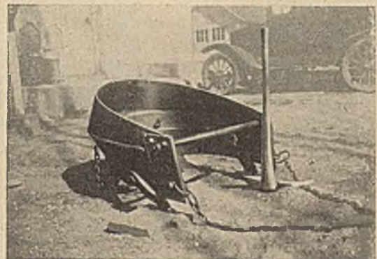
Abb. 5. Eimer für Kabelbagger.
