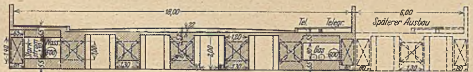
Abb. 24. Melan-Entwurf Butzer-Spangenberg, Querschnitt der Hauptöffnung, 3,5 m vom Scheitel entfernt.
