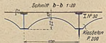
Abb. 17. Schema der Belastungsprobe.
