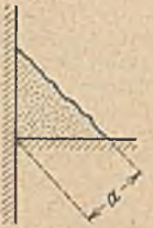
Abb. 2. Kehlnaht. a = Berechnungsdicke.
