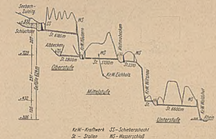
Abb. 2. Schematischer Längsschnitt durch das Schluchseewerk.
