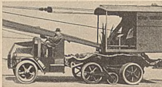
Abb. 5. Amerikanischer Automobilkran mit hochgeklappten Raupenbändern.
