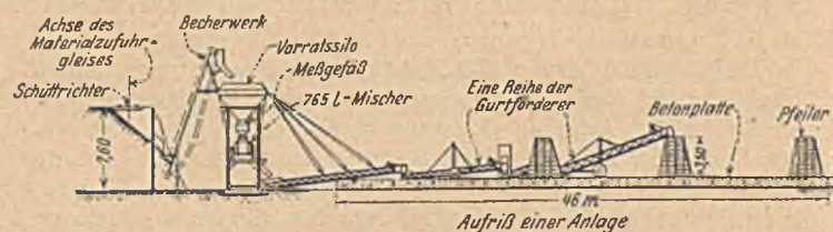
Abb. 1. Anordnung der Betonieranlage.
