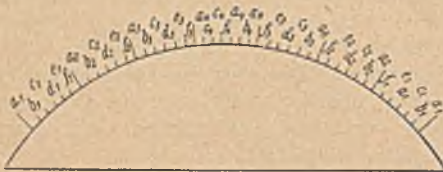
Abb. 13. Schema für das Einbringen des Bogenbetons.
