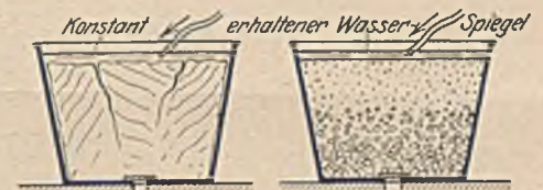
Abb. 7. Versuchsordnung zur vergleichweisen Ermittlung des Verhaltens von ausgetrocknetem Ton und Sand unter geringem Wasserdruck.
