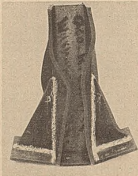
Abb. 3. Versuchskörper der Gruppe 1 nach dem Versuch.
