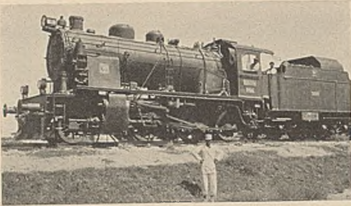
Abb. 12. 1—C Heißdampflokomotive der neuen persischen Staatsbahn.
