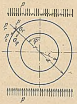
Abb. 4. Rohr unter Erddruck.
