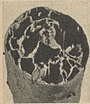
Abb. 2. Von Termiten völlig ausgehöhlter Holzpfosten.
