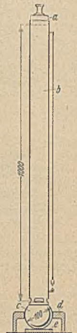
Abb. 9. Vorrichtung zum Messen der Plastizität bituminöser Straßenbeläge.
