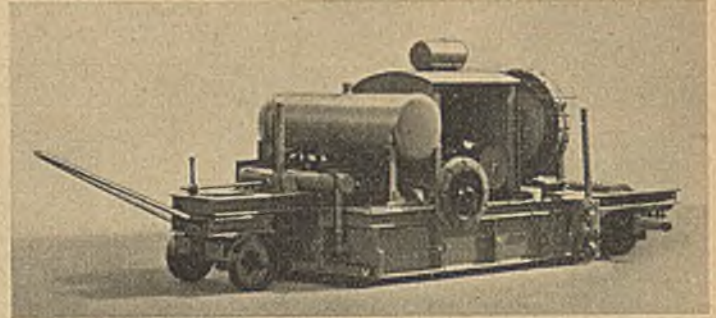
Abb. 14. Maschine zum Anwärmen und Prägen alter Stampf-Asphalt-Straßendecken von E. Linnhoff, Maschinenfabrik und Kesselschmiede, Berlin-Tempelhof.
