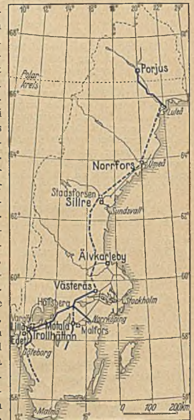
Abb. 3. Staatliche Kraftwerke und Kraftleitungen in Schweden. □ Kraftwerke und Stammleitungen nach dem Stand v. Jahr 1933. ▤ Kraftwerke und Stammleitungen im Bau oder projektiert. — Hauptleitungen nach dem Stand vom Jahr 1933.
