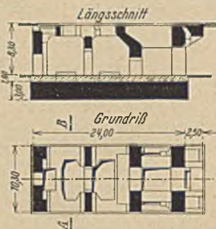
Abb. 4. Beispiel eines Turbinenfundamentes mit hochliegenden Eigenschwingzahlen.
