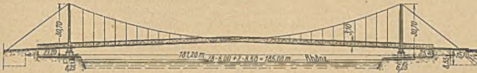
Abb. 1. System der neuen Brücke.
