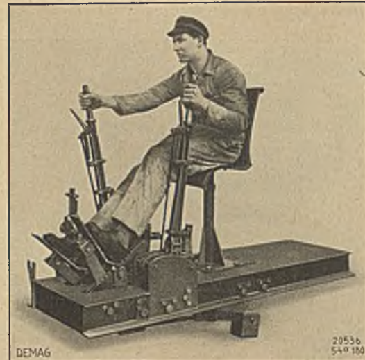
Abb. 11. Führersitz eines Baggers mit den Steuerhebeln.
