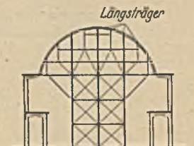
Abb. 11. Schema der für den Schalenbau verwendeten Gerüste.
