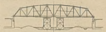
Abb. 7. Absetzen auf die Widerlager.
