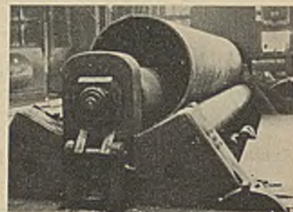
Abb. 11. Ausglühen und Runden der Rohre.
