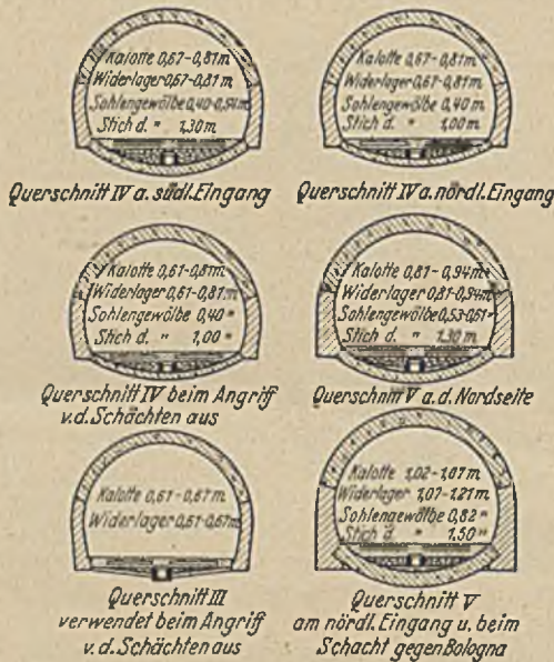
Abb. 9. Querschnitt des Tunnels.
