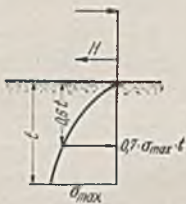
Abb. 37. Engels Annahme der Erdwiderstandsverteilung.
