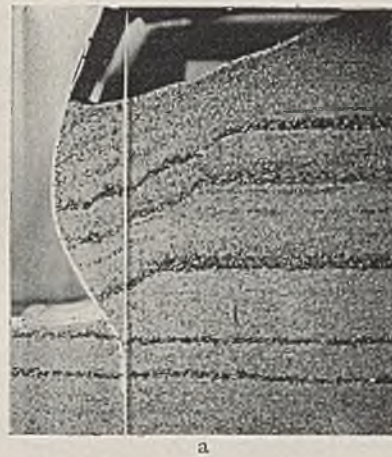
Abb. 32. Erddruckversuch II mit sehr nachgiebiger Wand.
