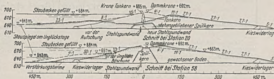
Abb. 2. Rutschkörper des Fort Peck Staudammes. Schnitte bei Station 20 und Station 58.
