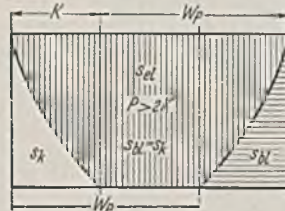
Abb. 7. Q-Fläche für den dritten Belastungszustand.
