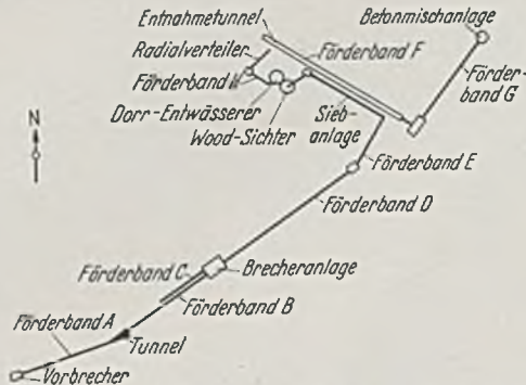
Abb. 1. Verlauf der Zuschlag- und Sandgewinnung vom Steinbruch bis zum Betonmischer.
