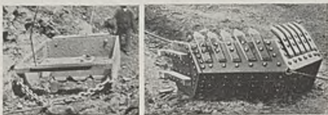
Abb. 5. Verschiedene Schrappergefäße der Demag AG.
