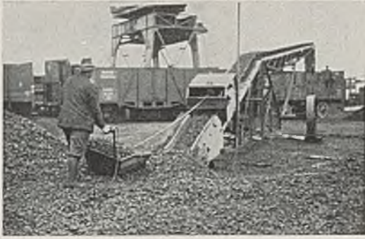
Abb. 12. Handschraper mit Förderband beim Beladen eines Eisenbahnwagens. Maschinenfabrik Emil Wieger.
