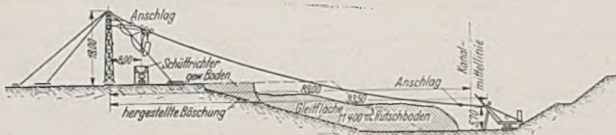
Abb. 14. Lageplan eines Kabelbaggers beim Beseitigen von Rutschböden.
