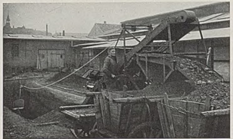
Abb. 10. Kleiner Schrapper von Schmidt, Kranz & Co. AG. zum Verladen von Massengütern.
