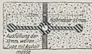
Abb. 2. Dichtung der Bauart B.
