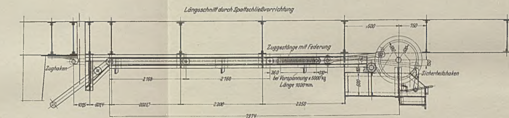
Abb. 34. Längsschnitt durch Spaltschließvorrichtung.
