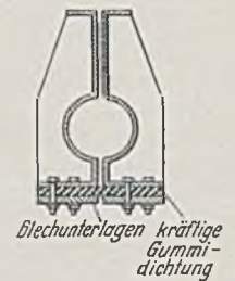
Abb. 4 b. Schnitt durch die Dichtung.
