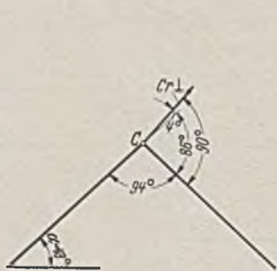
Abb. 9. Sparrenauflegerkräfte am First.
