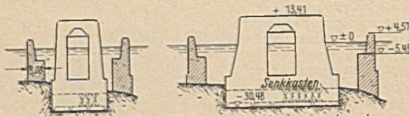
Abb. 1. ursprünglicher Plan - Pfeiler und Schutzmauer getrennt
