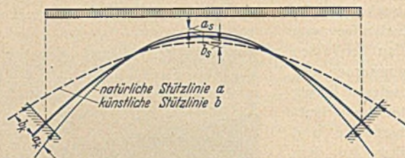
Abb. 3. Natürliche und künstliche Stützlinie des eingespannten Bogens.
