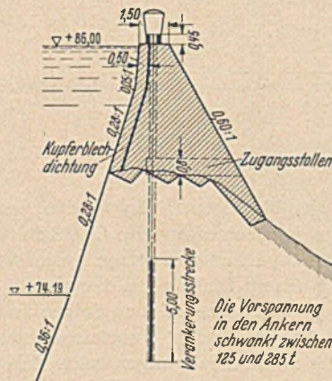
Abb. 16. Wiederherstellung der Fergoug-Staumauer und Verstärkung durch Zuganker.
