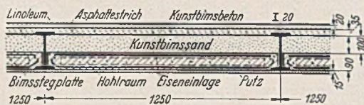
Abb. 2. Regelquerschnitt der Zwischendecken. Haus Hensoltshöhe.
