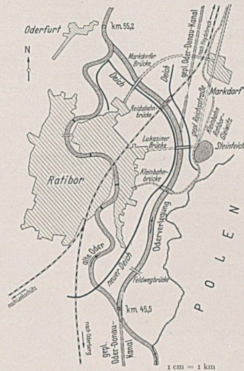
Abb. 11. Lageplan der Oderverlegung bei Ratibor. (Durch die neue Linienführung wird der Oderlauf um 2 km verkürzt. Die höchste abzuführende Wassermenge beträgt rd. 2000 m 3 /s.)
